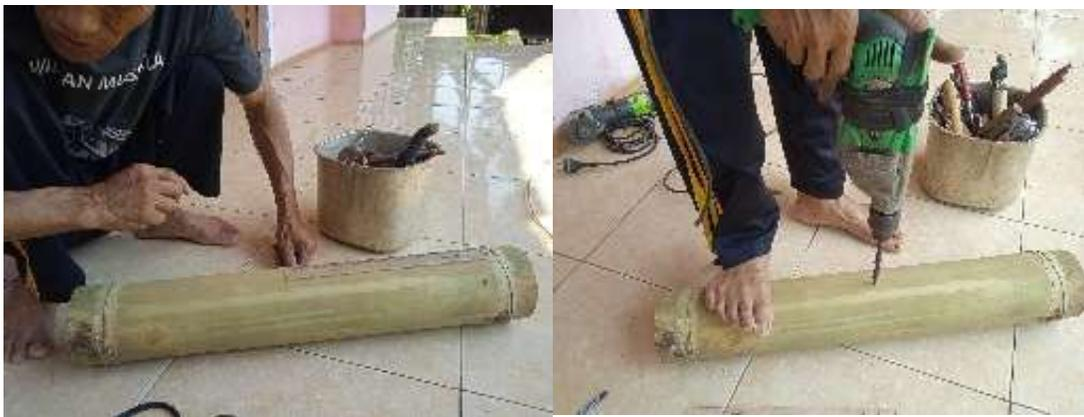
Gambar 3. Proses pengukuran titik tengah dan pengeboran lubang
